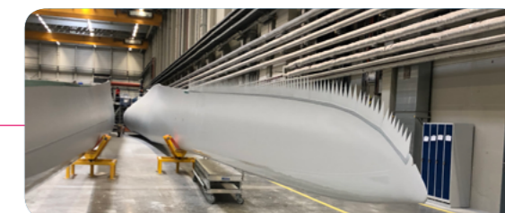
Exemple de pale équipée de peignes acoustiques appelés "serrations"
